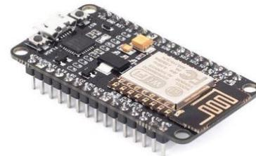
**Fig. 1. NodeMCU Board**
