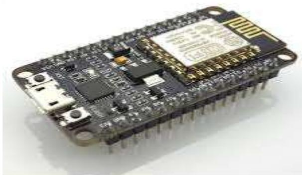
*Fig. 2. Nodemcu.*
