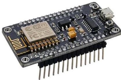
**Figure 2: NodeMCU –ESP8266**
