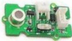
**Figure4: Alcohol sensor**
