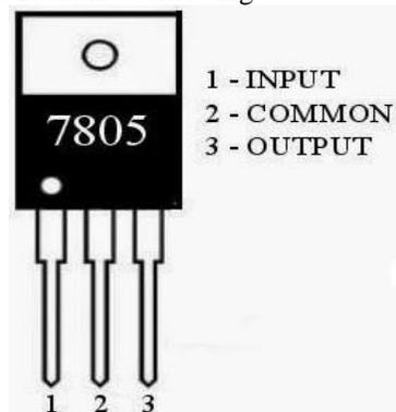
**Input:** Input voltage (5V)
