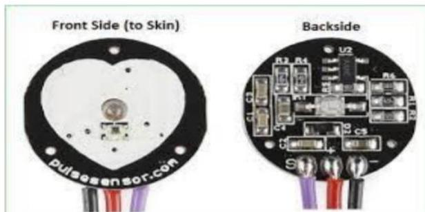
**Fig: 2.2. Pulse Sensor**
